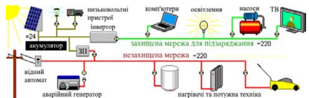
Рис. 7. Схема електропостачання із захищеним сегментом, що заряджається
