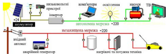
Рис. 5. Схема електропостачання з автономним захищеним сегментом на сонячній батареї
