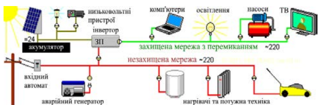
Рис. 6. Схема електропостачання з захищеним сегментом з перемиканням (ЗП – вбудований в інвертор зарядний пристрій)
